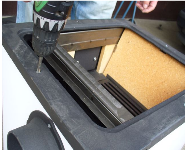
Wykręcenie śrub ramy płyty
