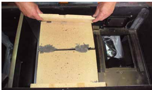
Wyjęcie szamotu przedniego nad piekarnikiem
