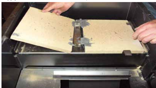
Wyjęcie szamotu 1. nad piekarnikiem
