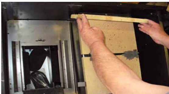
Wyjęcie szamotu tylnego nad piekarnikiem
