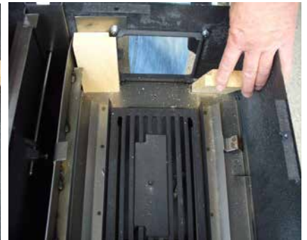
Wyjęcie bocznego szamotu od strony drzwi paleniska
