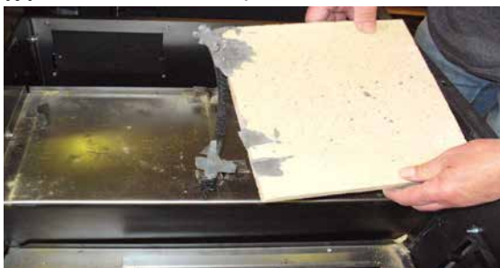
Wyjęcie szamotu 2. nad piekarnikiem
