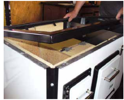
Wyjęcie dużego bocznego szamotu
