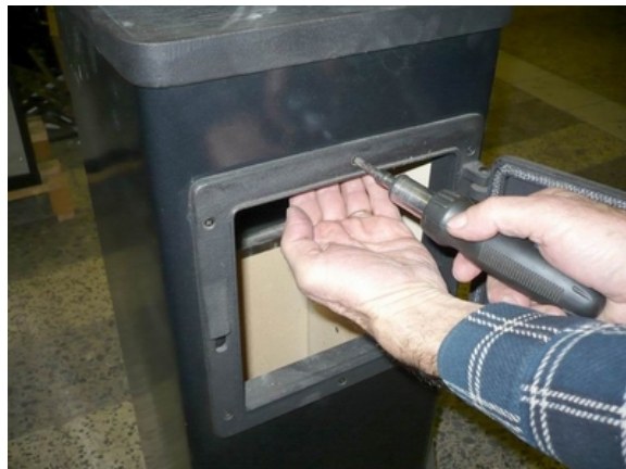
wykręcenie śrub mocujących, zdjęcie ramy drzwi paleniska/popielnika
