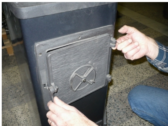
Wyjęcie 2 szt. sworzni, zdjęcie drzwi paleniska/popielnika
